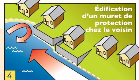
L'érosion engendrée en aval de la structure de protection entraîne le voisin à faire de même afin de protéger sa propriété, relayant le problème au suivant.
