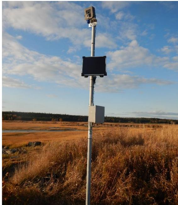
**Figure 22.** Caméra de suivi installée avec un panneau solaire et une batterie.
