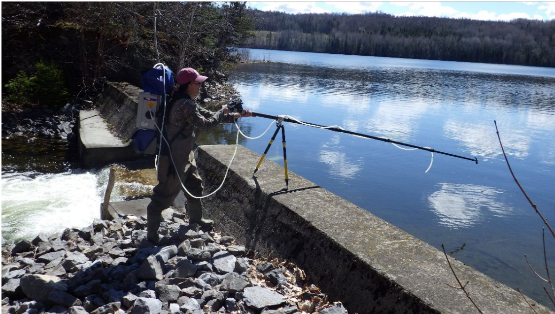
Utilisation du Backpack ADNe au lac à l'Anguille à la fin du printemps 2026.
